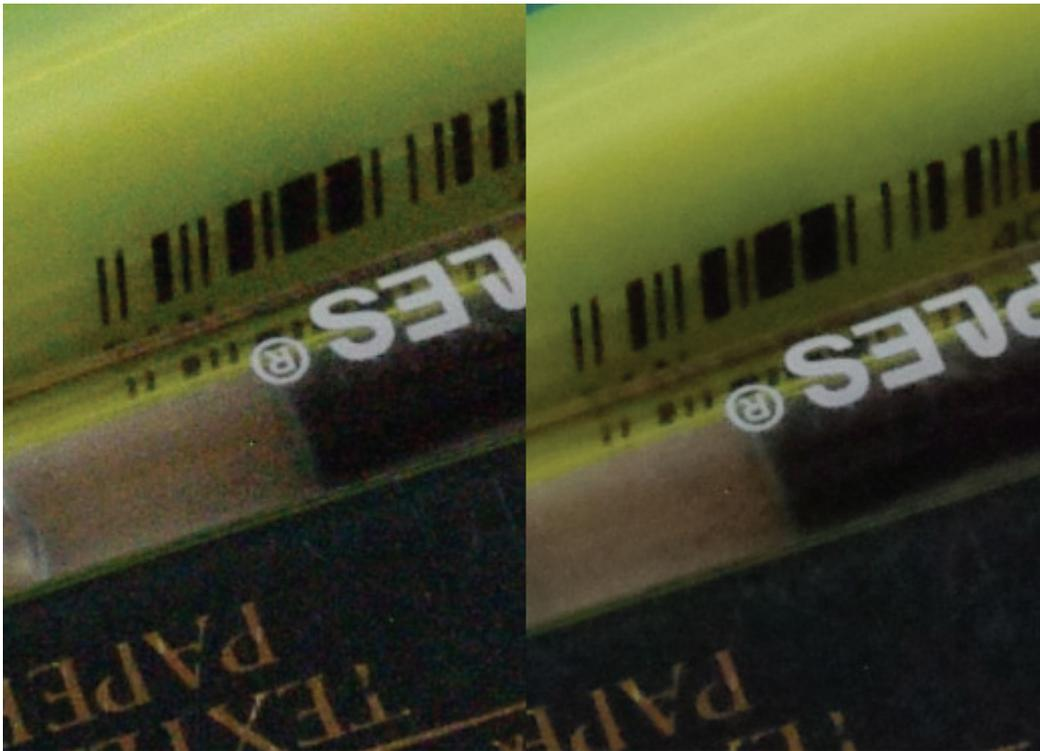
**ISO 1600 ohne Rauschreduzierung (links) und mit starker Rauschreduzierung**
