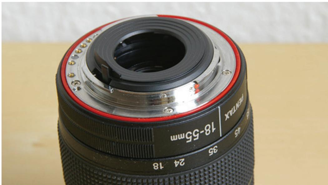
**Bajonett mit Dichtungsring beim DA 18-55 WR**
