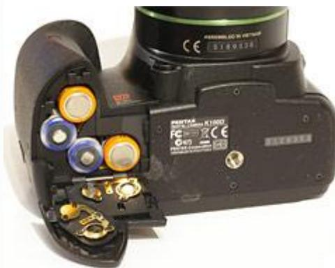
Die **Stromversorgung** der Kamera erfolgt über Batterien oder Akkus des Typs AA. Vier Batterien werden mitgeliefert, die reichen aber gerade für die ersten Fotos. Empfehlenswert sind gute NiMH-Akkus. Ich habe mit GP 2000mAh- und Sanyo 2100mAh-Akkus getestet, die schon etwas älter sind. Aktuelle Empfehlungen gehen fast alle zu den Sanyo Eneloop-Akkus, die für ca. 13 Euro im 4er-Pack zu bekommen sind. Wichtig ist in jedem Fall ein gutes Ladegerät, sonst sind die Akkus schnell kaputt geladen.
