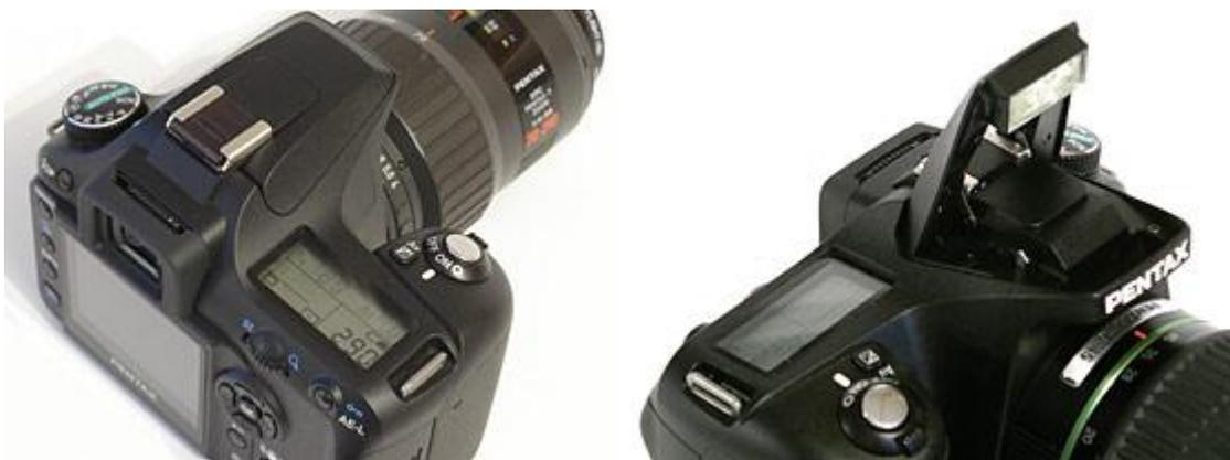
Auf der Kamera-Oberseite befindet sich zusätzlich ein **LCD-Statusdisplay**, das wichtige Kameraeinstellungen zeigt. Leider gibt es keine Möglichkeit der Beleuchtung für dieses Display, so dass man bei Dunkelheit nur das große Display zur Kontrolle der Einstellungen zur Verfügung hat. Sowohl im Sucher als auch im LCD-Statusdisplay wird der eingestellte ISO-Wert bei Drücken der OK-Taste angezeigt, verändert werden kann er aber nur über das Fn-Menü.
