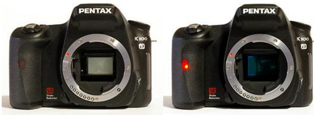
Während der Sensor selbst also eher unspektakulär ist, hängt doch eine innovative Neuerung damit zusammen: das **ShakeReduction-System**. Dabei wird der Sensor beweglich gelagert und mit Elektromagneten gesteuert, so dass durch den Fotografen bedingte Verwacklungen verringert werden. In der Praxis entsteht dadurch ein Vorteil von 2-3 Blendenstufen.
