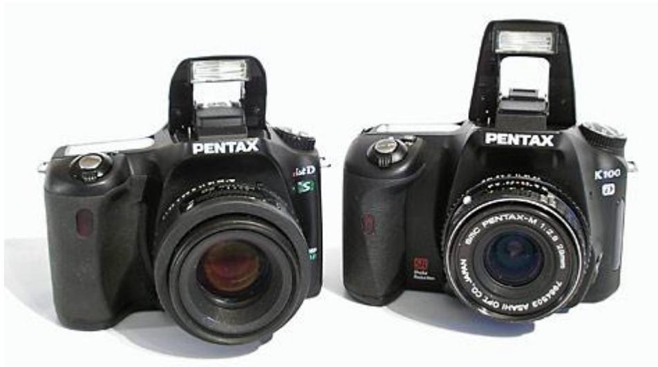
Der **interne Blitz** kann bei Bedarf auf Tastendruck aufgeklappt werden oder klappt sich in den Motivprogrammen automatisch auf. Seine Leitzahl beträgt 15,6 bei ISO 200, der Ausleuchtungswinkel 28 mm (entsprechend KB-Format). Über das Menü kann eine Blitzbelichtungskorrektur von -2 bis +1 LW eingestellt werden, die kürzeste Blitz-Synchronzeit liegt bei 1/180 sek.
