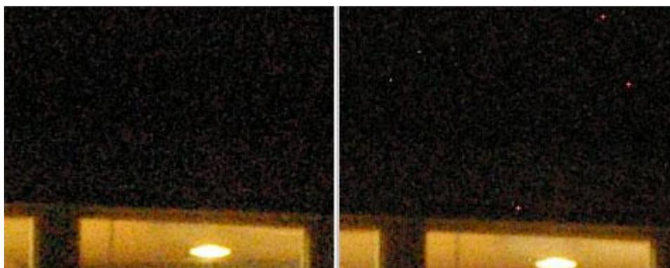
Und hier nochmal der Ausschnitt (1:1-Ansicht) mit ISO 3200 bei 6 sek - links mit Rauschunterdrückung, rechts ohne. Das Grundrauschen bei ISO 3200 ist natürlich relativ hoch, aber im gesamten Foto lassen sich keine Hotpixel
