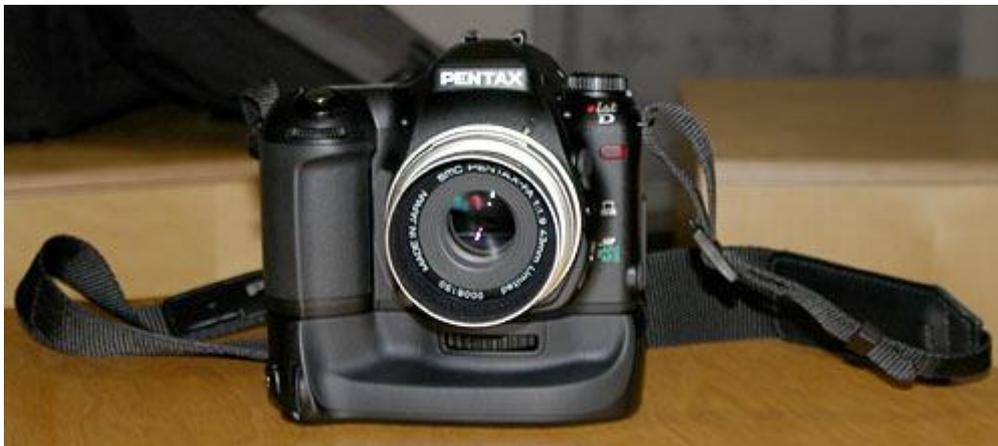
Sind Kamera und Batteriegriff mit Akkus bestückt, so werden laut Pentax immer die Akkus mit der höchsten Spannung verwendet und sind z.B. in der Kamera leere Akkus oder gar keine, werden nur die aus dem Batteriegriff verwendet. Das ist auch sinnvoll, weil man an den Akkuschacht der Kamera nur durch Entfernen des Batteriegriffs gelangen würde. Eine Befestigung für einen Kamerariemen gibt es leider nicht an dem Griff.
