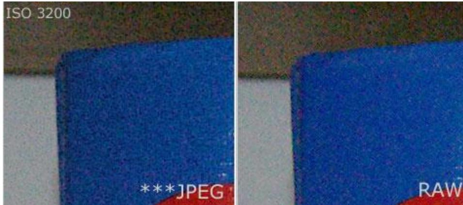
Die beiden Beispielausschnitte zeigen, dass die RAW-Datei etwas sauberer aussieht - allerdings hat sie auch in JPEG umgewandelt über 7 MB, während die \*\*\*JPEG-Aufnahme direkt aus der Kamera nur ca. 4 MB hat. Möglich also, dass ein Teil des Unterschieds auf verschieden starke JPEG-Komprimierung zurückzuführen ist. Genauer beurteilen kann ich das zum jetzigen Zeitpunkt aber nicht.
